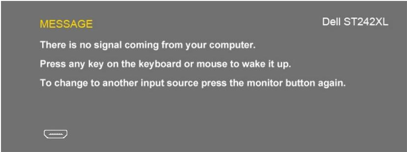
Jika masukan VGA/DVI/HDMI dipilih dan baik kabel VGA, DVI maupun HDMI tidak tersambung, maka kotak dialog melayang seperti terlihat di bawah ini akan muncul. Monitor akan beralih ke **Power Save Mode after 15 minutes** (Mode Hemat Daya setelah 15 menit) jika dibiarkan dalam kondisi ini.
