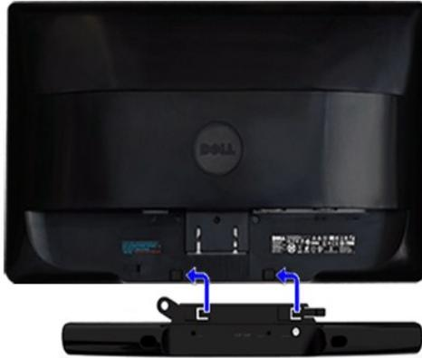
1. Dengan bekerja dari belakang monitor, pasang Soundbar dengan meluruskan dua slot dengan dua tab di sepanjang belakang bawah monitor.
