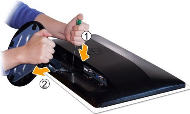
Setelah meletakkan panel monitor di atas kain halus atau bantal, lakukan langkah berikut untuk melepas alas.
