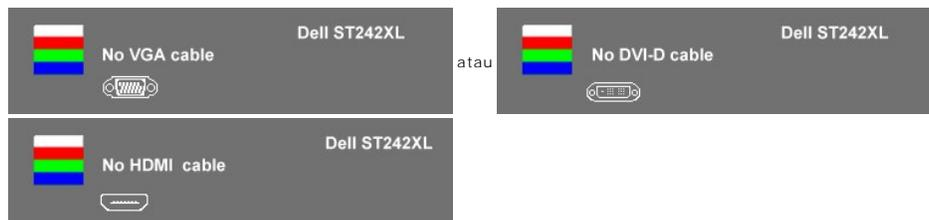
4. Kotak ini juga muncul selama pengoperasian sistem normal, jika kabel video menjadi terlepas atau rusak. Monitor akan beralih ke **Power Save Mode after 15 minutes** (Mode Hemat Daya setelah 15 menit) jika dibiarkan dalam kondisi ini.
